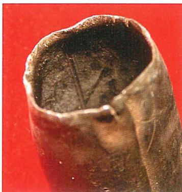
Particolare di una canna del Ripieno; l'asse di mezzeria all'interno del corpo, dalla parte opposta alla saldatura longitudinale.
