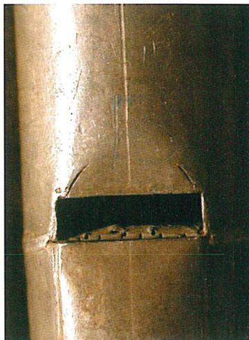
Particolare di una canna del Flauto montata “al rovescio”; sono visibili l'asse di mezzeria del corpo e le tracciature della larghezza di bocca (prima del restauro).
