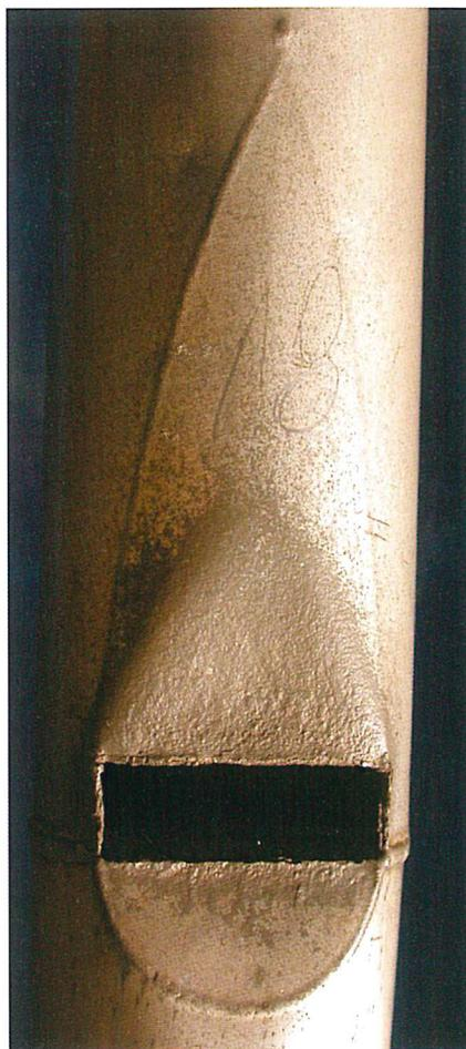
Canna di stagno del Principale di facciata; particolare della bocca; sono ben visibili l'articolato profilo del labbro superiore e gli effetti della corrosione del metallo.
